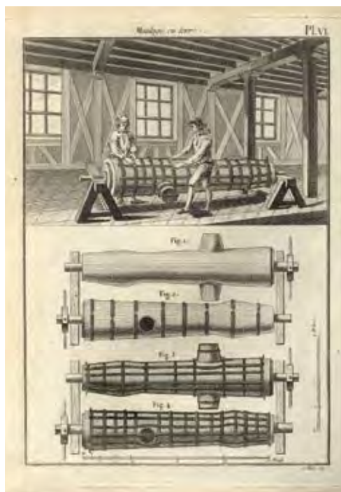
Moldes para fabricação de canhões. ENCYCLOPÉDIE DE DIDEROT ET D'ALEMBERT, 1751
